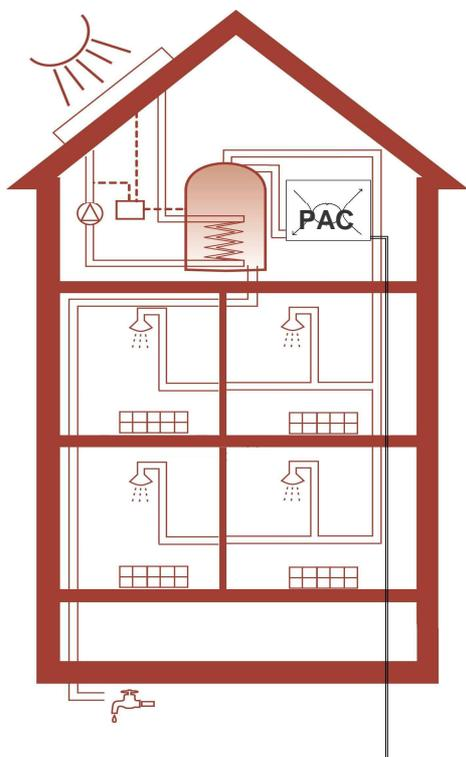
Un système solaire collectif composé de 17 m<sup>2</sup> de capteurs plans et d'un ballon de stockage commun (voir schéma) alimente les quatre logements en chauffage et eau chaude sanitaire (ECS).
